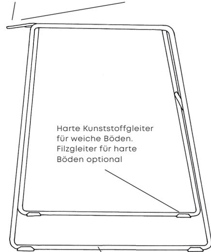
Ø14 mm massiver Stabstahl in Chrom oder Pulverbeschichtung
