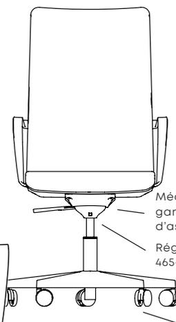
Mécanisme d'inclinaison garantissant un confort d'assise optimal
